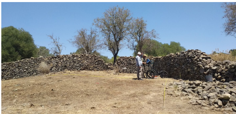
Figura 7. Trabajos de prospección geofísica con GPR, en la zona de la Cercas de las Alcarias, a cargo del Laboratorio de Geofísica y Sismología de Universidad de Évora, liderado por Bento Caldeira.
